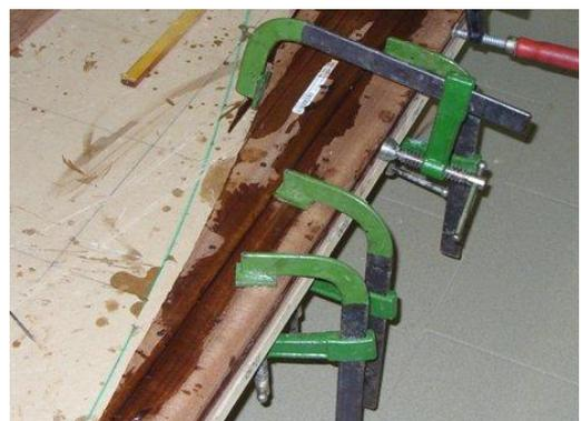
sui pezzi e li abbiamo fissati nuovamente con i morsetti. All'inizio quest'operazione l'abbiamo effettuata sulla parte frontale del longherone mentre dopo nella parte posteriore. Incollati anche questi ultimi pezzi e fissati con altri morsetti li abbiamo lasciati asciugare.
