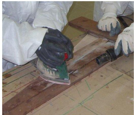
A forza di levigare, la superficie è diventata liscia. Una volta tagliati tutti i pezzi li abbiamo pressati e fissati tutti assieme bene prima con i morsetti e poi con le viti sulla parte dello scalo dove c'era il longherone centrale. Prima di incollare, visto che non avevamo il composto abbiamo calcolato su una bilancia le dosi della resina e del catalizzatore uniti, e una volta mescolato il tutto lo abbiamo steso
